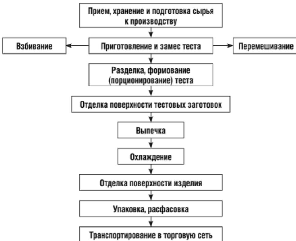
Рис. 2. Технологическая схема приготовления мучных кондитерских изделий
